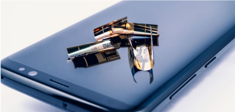
Flexibel capacitief identificatielabel dat communiceert met standaard touch screens.
