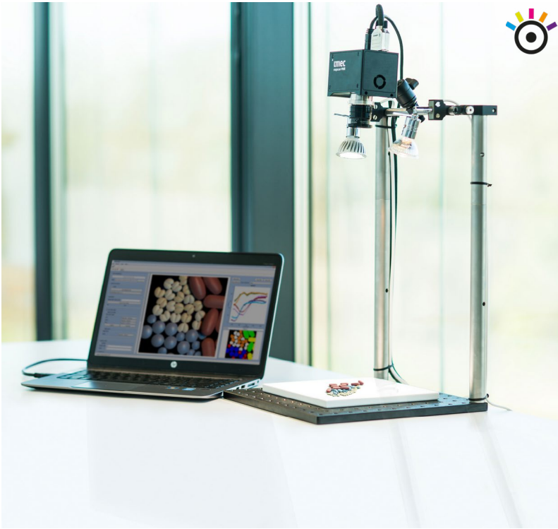
Imecs ultrasone SNAPSCAN-camera met hoge snelheid maakt hyperspectrale beeldvorming mogelijk in minder dan één seconde.
