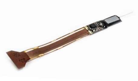
Neuroprobe die elektrische en chemische registratie en stimulatie van enkelvoudige neuronen mogelijk maakt.
