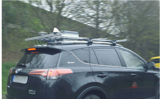
Nieuwe communicatie-, data- en sensortechnologieën om geconnecteerde wagens te testen en te valideren binnen het Smart Highway-project.
