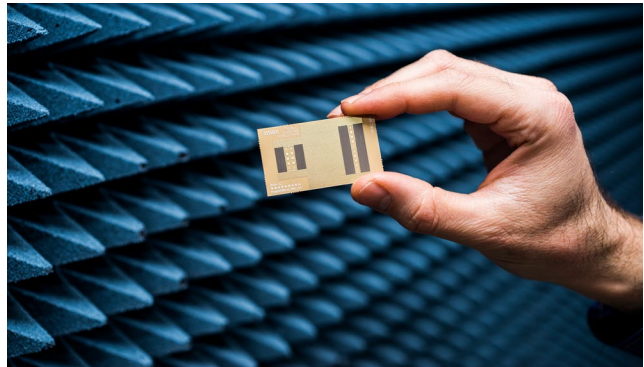
Een phased-antenne-array, sterk geïmplementeerd in een CMOS-chip, incl. 2 actieve transmissie- & 2 actieve ontvangstketens.
