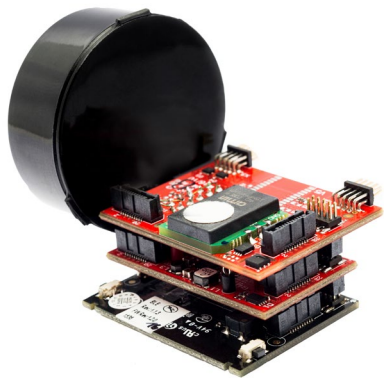
Multi-sensornode voor milieumonitoring.
