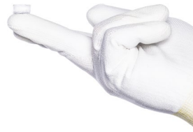
Imecs vaste nanocomposietelectrolyt is de basis voor onze vastestofbatterijtechnologie.
